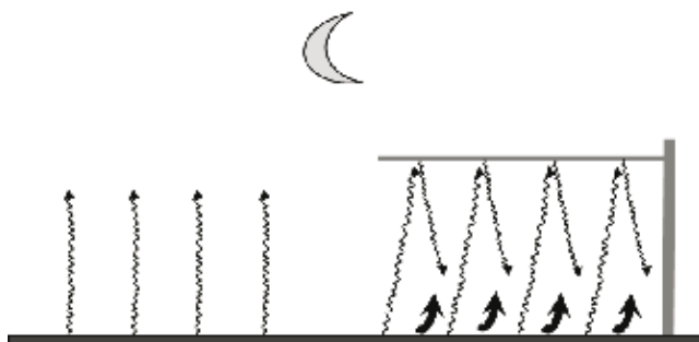
Ryc. 2. Schemat działania markizy refleksyjnej (wążykowate strzałki – promieniowanie długofalowe, strzałki pogrubione – efekt ogrzewania)
