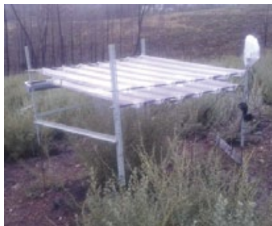
Ryc. 6. Schemat działania rynienek przeciwdeszczowych (po lewej), rynienki przeciwdeszczowe na stanowisku manipulacyjnym (po prawej) – eksperyment CASCADE, Góry Caramulo, Portugalia (fot. B.H. Chojnicki)
