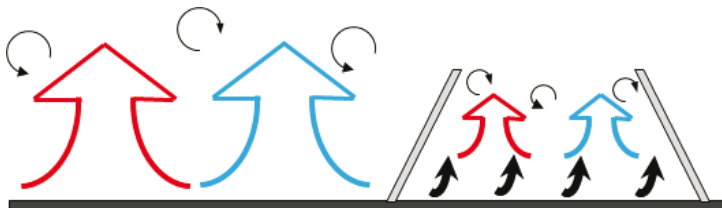
Ryc. 1. Schemat działania komory otwartej (strzałki okrągłe – turbulencja, strzałki czarne pogrubione – efekt ogrzewania, strzałki niebieskie – transport pary wodnej, strzałki czerwone – transport ciepła) Fig. 1. Field warming with Open Top Chamber (OTC) where: circle arrows – turbulence, thick arrows – warming effect, blue arrows – water vapor vertical transport, red arrows – heat vertical transport
