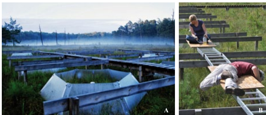
Ryc. 2. A) Eksperyment manipulacyjny w projekcie CLIMPEAT. Na torfowisku zastosowano heksagonalne klosze, które podnoszą temperaturę torfowiska (Fot. Jan Barabach); B) Prace badawcze na torfowisku wymagają dużych nakładów finansowych i wiele czasu spędzonego w terenie (Fot. Mariusz Lamentowicz)
